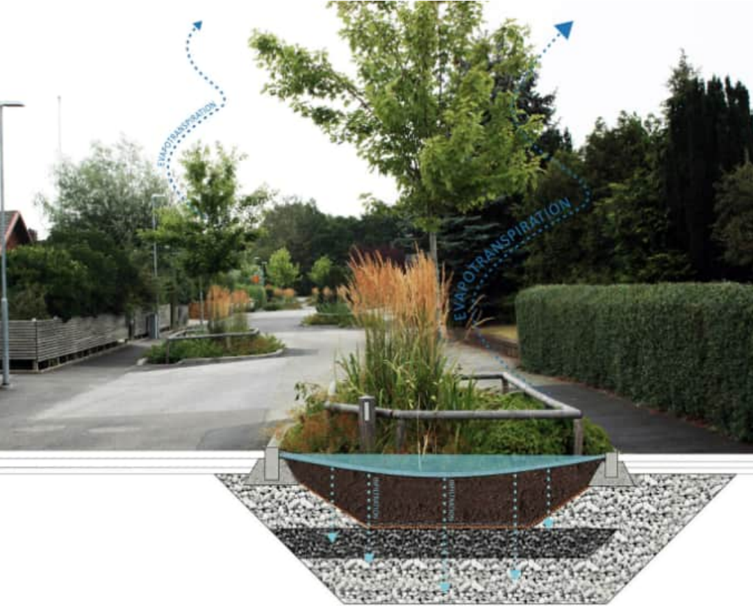
Příklad řezu dešťovým záhonem. Zdroj: Atelier YYYY
