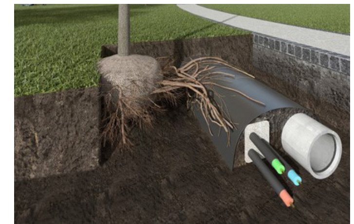
způsob ukládání ochranné bariéry (zdroj Rootcontrol)
