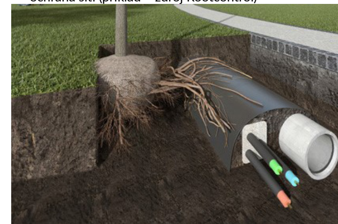
způsob ukládání ochranné bariéry (zdroj Rootcontrol)
